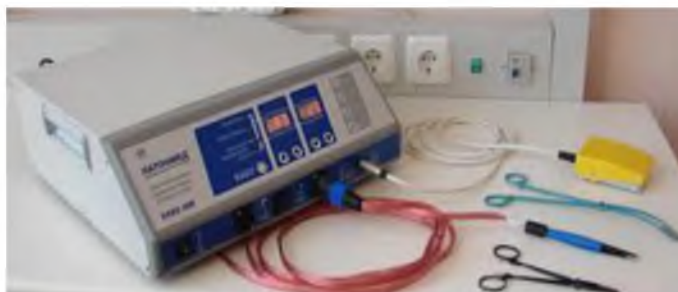
Рис. 2.2 Зображення апарату для електрозварювання тканин ЕКВ3-300 «Патонмед»
